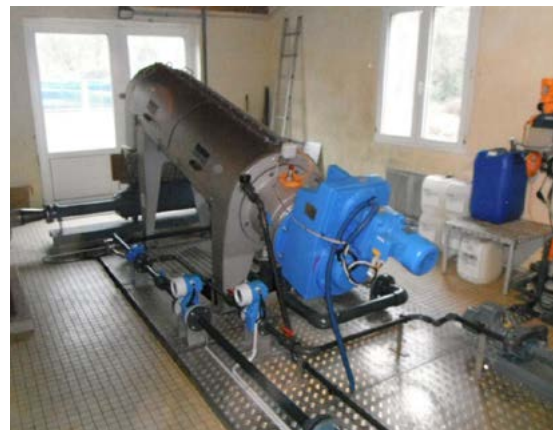
Description d'une presse à vis Source : CIRSEE
